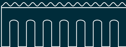
Gerade mit Ausklindung (GmA) Straight and notched (SN)
